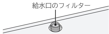
●給水口のフィルターを外した場合は、元どおりに取り付けてください。取り付けないと、給水弁の故障の原因になります。
