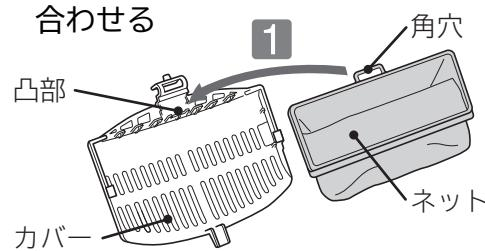
2 片方の「つめ」の内側にネットの枠を差し込む
