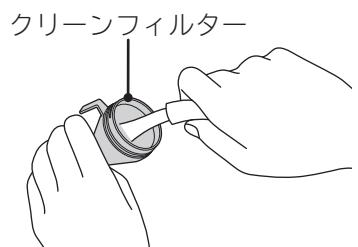
強めの水道水をホースに流し、内部のゴミを洗い流す。
