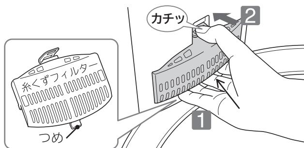
●糸くずフィルターを取り出したとき、洗濯・脱水槽のくぼみにヘアピンや硬貨などを落とさないように注意してください。
