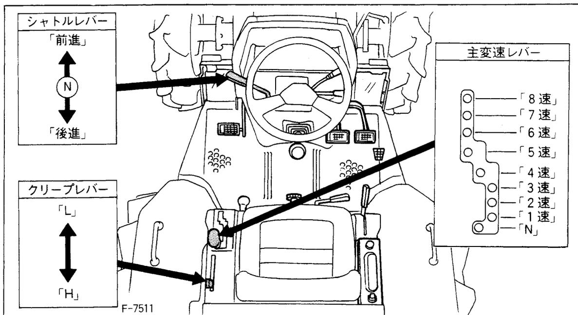
3本のレバー操作を組合せることにより前進16段、後進16段の車速が得られます。
