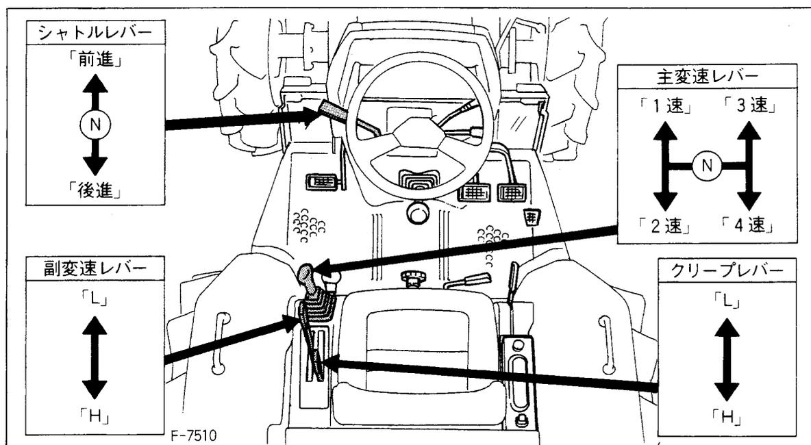
4本のレバー操作を組合せることにより前進16段、後進16段の車速が得られます。
