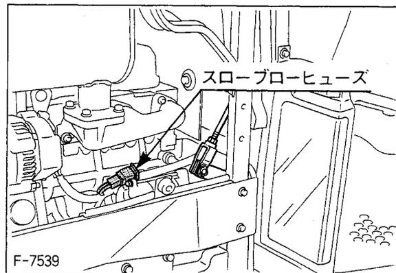
スローブローヒューズは、配線を保護するためのものです。もし切れた場合は、切れた原因を必ず調べ、決して代用品を使用せず、純正部品を使用してください。
