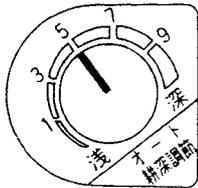
オート切換えスイッチが、「標準」・「敏感」・「Eオート」の場合、浅起しから深起しまで希望の耕深になるよう、このダイヤルで設定してください。
