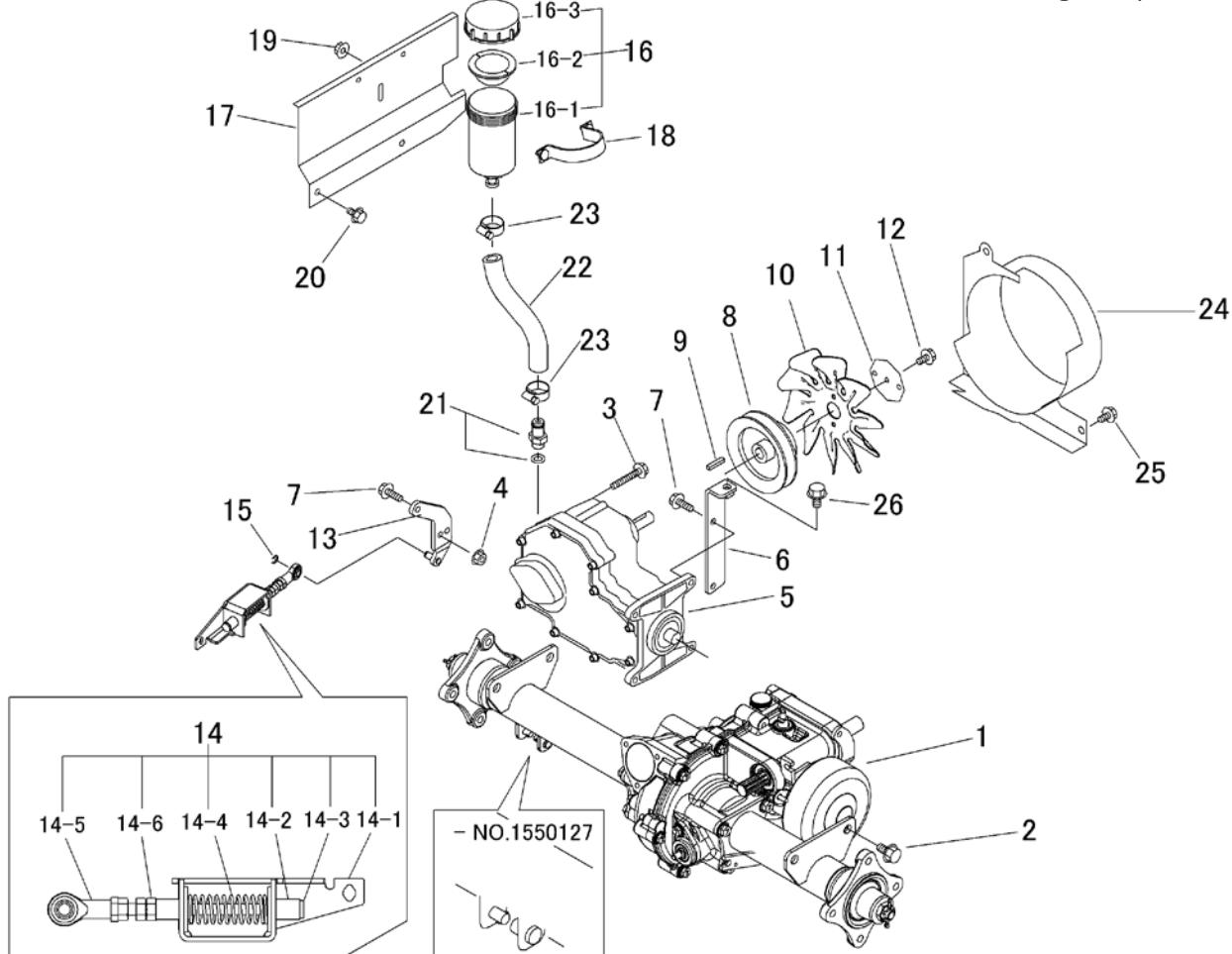
5346 200B ミッション CE USA ( チャージポンプ付 ) Transmission CE USA ( With Charge Pump )
