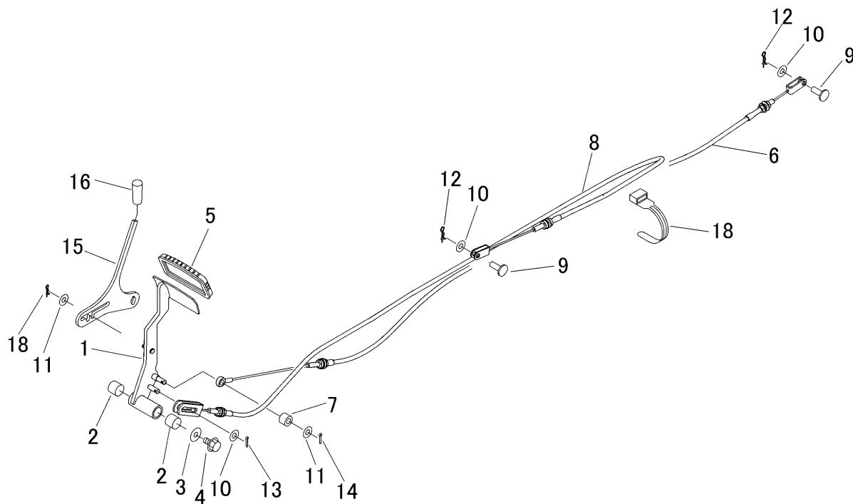
5346 330B ブレーキ( 左 前ブレーキ ) ( Asia ) Brake( Foot L with Front Brake )
