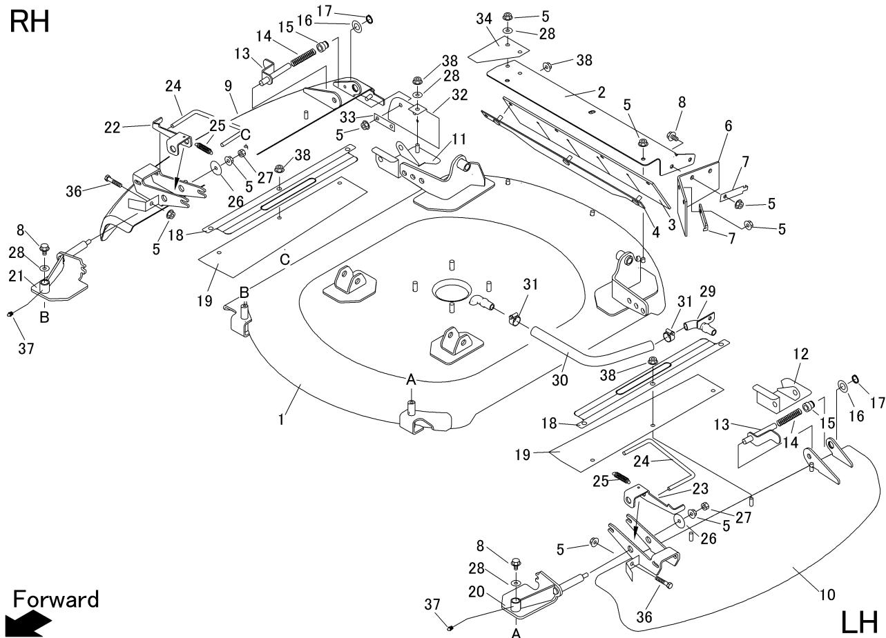
5347 410E カリハカバー( CE USA ) Cutting Blade Shield( CE USA )
