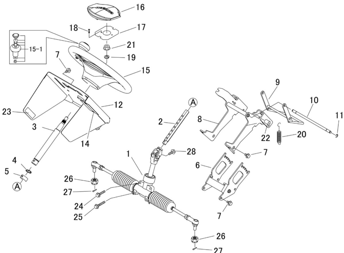
5347 310A 走行・操作レバー( 左ブレーキ 左HSTレバー ) Drive Lever( Brake L HST L )
